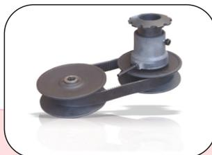
Раздвижные шкивы с неподвижной осью, автоматическая смазка круглой ступицы. Передача крутящего момента через шпонку. Ведущий шкив с и без рукоятки; ведомый шкив с цилиндрической пружиной.
