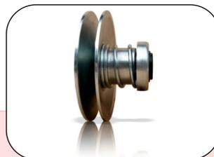
Раздвижные шкивы с цилиндрическими пружинами и автоматическая смазка круглой ступицы. Передача крутящего момента через шпонку.
